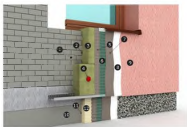
Рисунок 13. Устройство системы штукатурного фасада на минеральной вате
